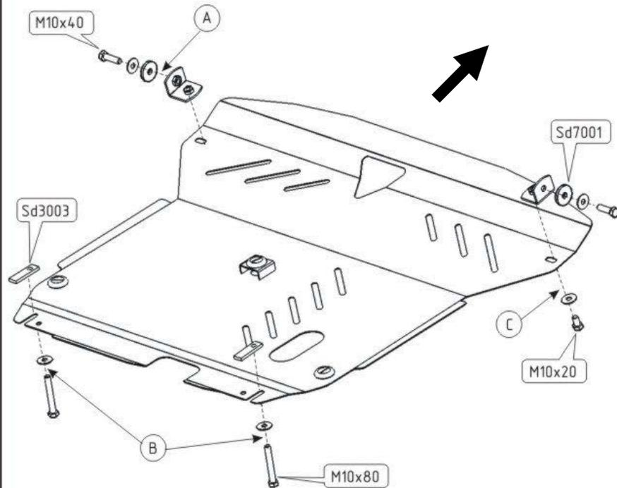
1. Winkel (D) an Abschleppösen mit Schrauben M10x40 und U-Scheibe SD7001 laut Abb. 1 und 2 befestigen.
