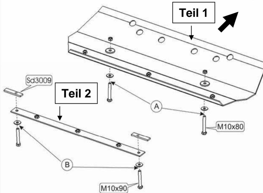
1. Unterfahrerschutz (Teil 1) an Querträger mit Schrauben M10x80 und Muttern M10 laut Abb. 1 und 2 (A) befestigen.
